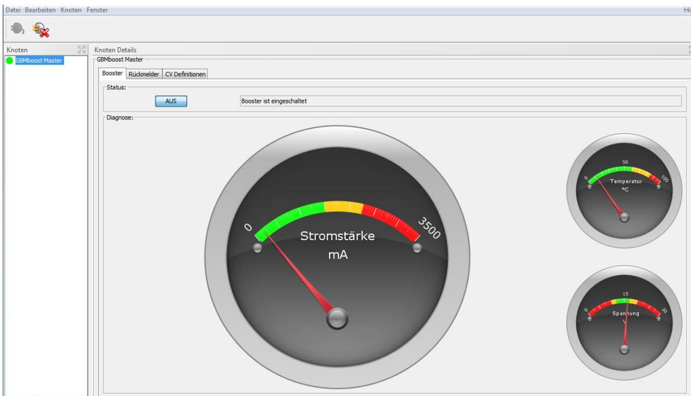
Intelligente Steuerungsprogramme am PC können so zum Beispiel bei überlasteten Abschnitten unwichtige Verbraucher (z.B. Wagenbeleuchtungen) ausschalten. Maßnahmen für eine Umfahrung von abgeschalteten Boosterabschnitte einleiten oder mit einer rechtzeitigen Erkennung der drohenden Überlastung, den Zug von der Abfahrt bzw. Einfahrt in den neuen Abschnitt hindern.
