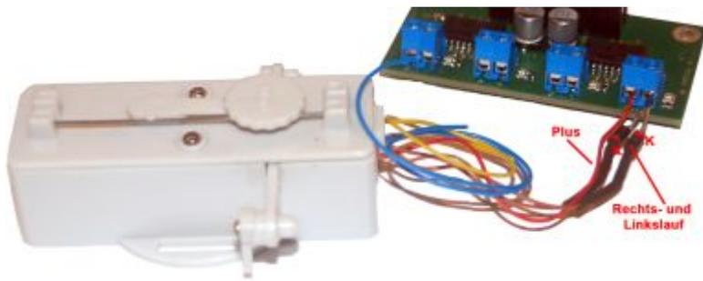
Mit Hilfe dieses Moduls können Schaltdecoder so erweitert werden, dass motorische Weichenantriebe geschaltet werden.
