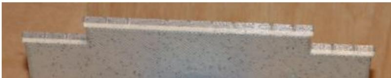
Ich glaube, jetzt wird es sehr deutlich was ich eigentlich zeigen bzw. sagen will. Beim FDM-Druck wird nun einmal Schicht für Schicht gedruckt. Dies ist nicht unbedingt immer ein Nachteil. In diesem Beispiel aber schon. Hier wäre es doch bestimmt besser, dass die Deckplatten oben, als auch die Platten in der Tunnelrundung stets die gleiche Farbe haben würden. Na und dies wäre bei einem Mehrfarben-Ausdruck halt möglich.
