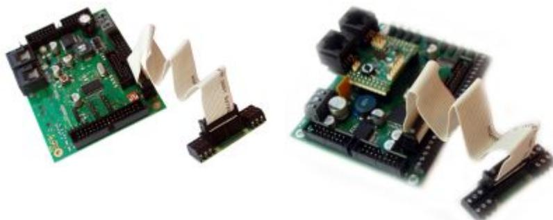
Die Breakout Platine wird über einem Flachbandkabel mit der Baugruppe verbunden.
