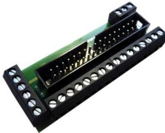
Diese kleine Zusatzplatine „**Breakout LED**“ ist eine Anschlussplatine für die LED-Ausgänge der LightControl!
