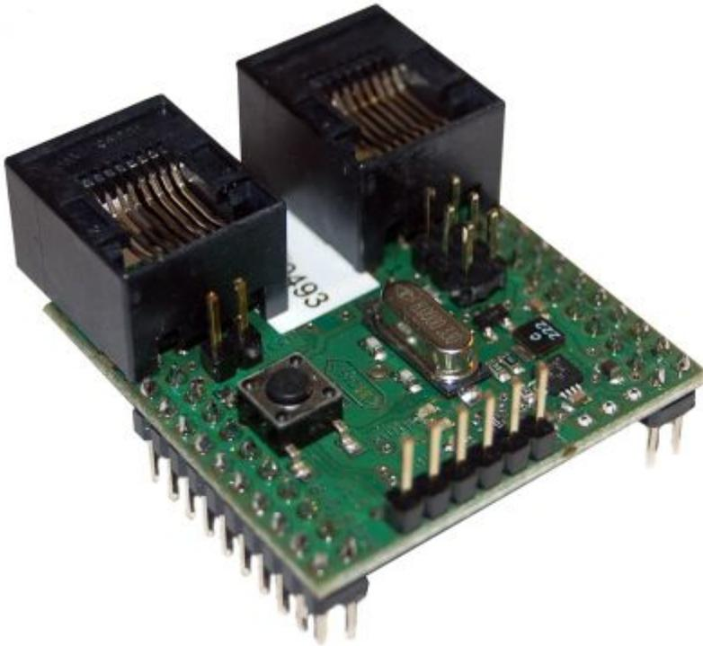
Der **BiDiBone** ist ein Aufsteckmodul für zahlreiche BiDiBone Addon-Platinen aus der One-Serie. z.B. OneDMX, OneHub, OneControl, ... Der BiDiBone liefert alle notwendigen Komponenten für einen BiDiB-Knoten. Er enthält ein Businterface, die BiDiB-Buchsen, den Identify-Taster und die Status-LED. Ein Schaltregler erzeugt die benötigten Spannungen von 5V und 3,3V, diese können auch zur Versorgung der Addon-Platinen verwendet werden.
