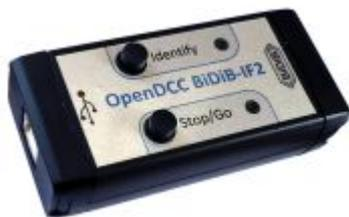
Das [BiDiB-IF2](#) (Digitalzentrale) in Kombination mit ReadyBoost (Booster) und [GBM16TS](#) (Belegtmelder) ist die minimal notwendige Ausstattung um Loks mit DCC-Dekoder auf einer Anlage zu steuern, oder BiDiB-Module mit dem PC zu verbinden. Der GBM16TS bietet dabei die Möglichkeit für den Anschluss von 16 überwachten Gleisabschnitten (alle RailCom-fähig).
