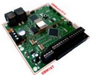
Alternativ zum IF2 bietet der [GBMBoost Master](#) eine Digitalzentrale mit dem BiDiB-Interface für weitere BiDiB-Baugruppen, einen Booster mit 4A DCC-Ausgangsstrom (und integriertem Boostermanagement) sowie den GBM16T, einen RailCom-fähigen Gleisbelegtmelder für 16 Gleisanschlüsse. Der [GBMBoost Master](#) versorgt ausserdem den BiDiBus mit 12V und bietet auch 2 XPNet-Anschlüsse, um z.B. einen entsprechenden Handregler anzuschliessen.
