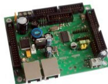
Je nach Wahl der Baugruppe geht der Schwerpunkt in Richtung **Beleuchten von Modellbahnszenarien, Effekt** und **Signalsteuerung von Lichtsignalen** oder **Schalten von Weichen**. Alle notwendigen Bauteile für den Betrieb dieser Baugruppe sind Bestandteil des SMD bestückten Bausatzes.
