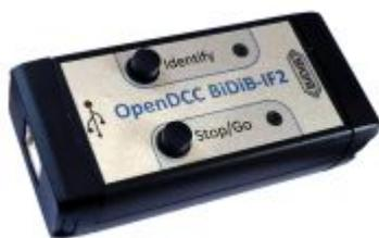
Das [BiDiB-IF2](#) (Digitalzentrale) in Kombination mit ReadyBoost (Booster) und [GBM16TS](#) (Belegtmelder) ist die minimal notwendige Ausstattung um Loks mit DCC-Dekoder auf einer Anlage zu steuern. Der GBM16TS bietet dabei die Möglichkeit für den Anschluss von 16 überwachten Gleisabschnitten (alle RailCom-fähig).
