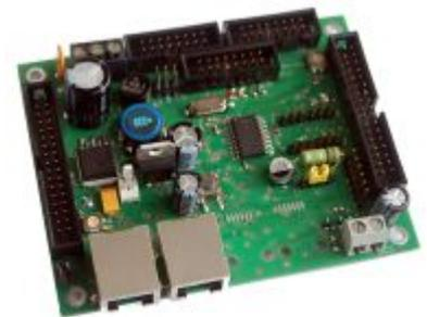
Je nach Wahl der Baugruppe geht der Schwerpunkt in Richtung **Beleuchten von Modellbahnszenarien, Effekt** und **Signalsteuerung von Lichtsignalen** oder **Schalten von Weichen**. Alle notwendigen Bauteile für den Betrieb dieser Baugruppe sind Bestandteil des SMD bestückten Bausatzes.
